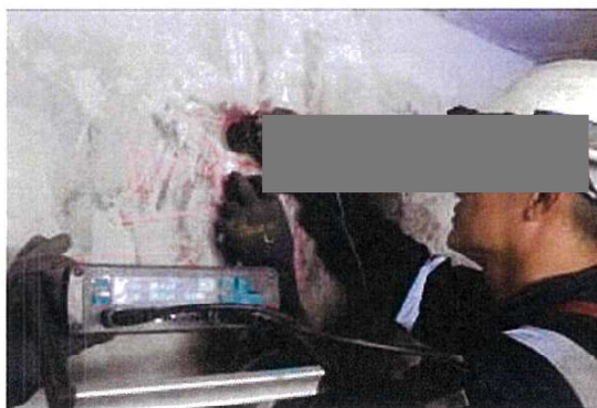
รูปที่ 14 : Ultrasonic Pulse Velocity Test ด้าน D
