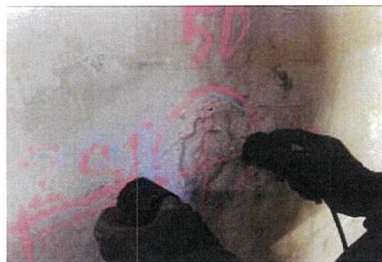
รูปที่ 17 : Ultrasonic Pulse Velocity Test ด้าน D
