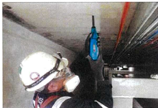
รูปที่ 8 : Rebound Hammer Test ผนังด้าน A
