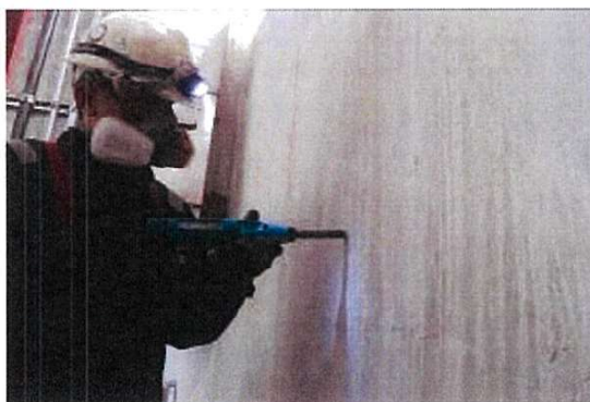
รูปที่ 7 : Rebound Hammer Test ผนังด้าน D
